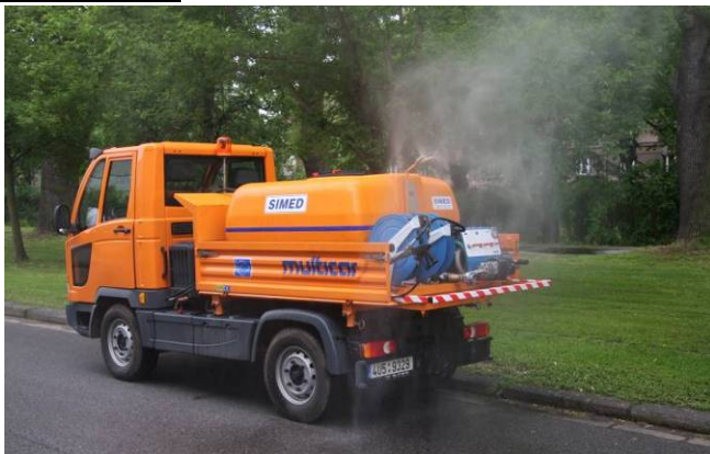
Hmlový systém – hmlová tryska sa nachádza na vrchu cisterny v zadnej časti
