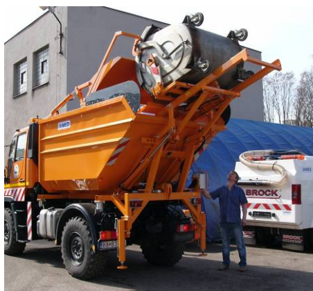
Lisovacia nadstavba sa montuje priamo na nosníky rámu vozidla.
